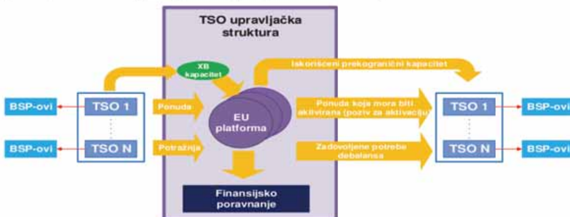
sl. 2 - Funkcionalni model evropskog balansnog tržišta električne energije zasnovan na konceptu zajedničke platforme za balansiranje
